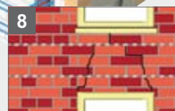
Sanierung gebrochener Massiv-Mauerstürze
